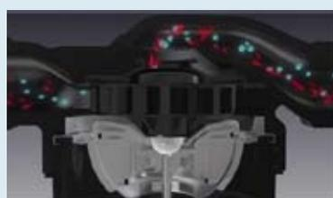
Il flusso principale del liquido pompato (blu) e le sue particelle di magnetite (rosse), sono mantenute al di fuori dall'area magnetica creata dal rotore.
